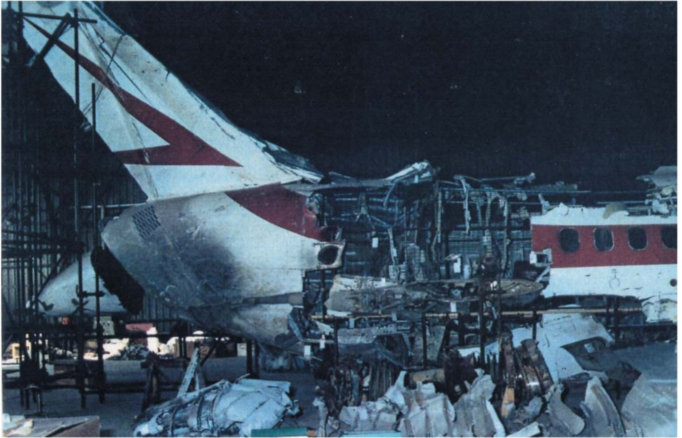
Il Dc9 a Pratica di Mare dopo la ricostruzione che permise ai periti di verificare l'enorme squarcio provocato dalla bomba nella toilette posteriore
